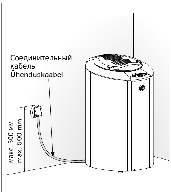
Рис. 8 Установка каменки Joonis 9. Kerise ühendamise
