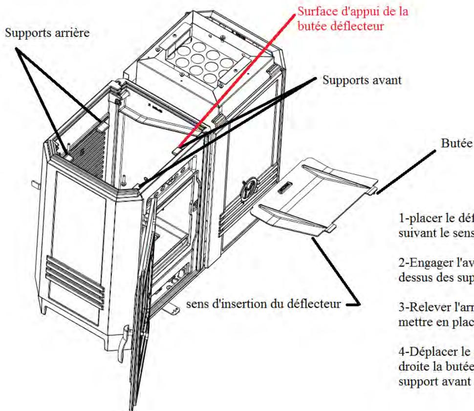
1-placer le déflecteur dans l'appareil suivant le sens indiqué ci-contre
