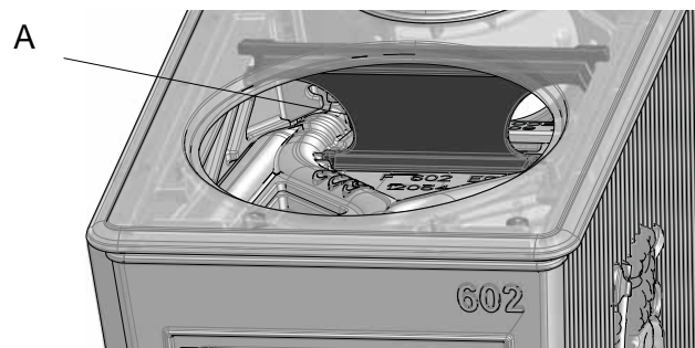
Fig. 27 Sustitución del deflector de escape
