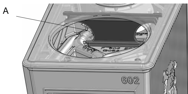
Fig. 27 Sostituzione del deflettore di scarico
