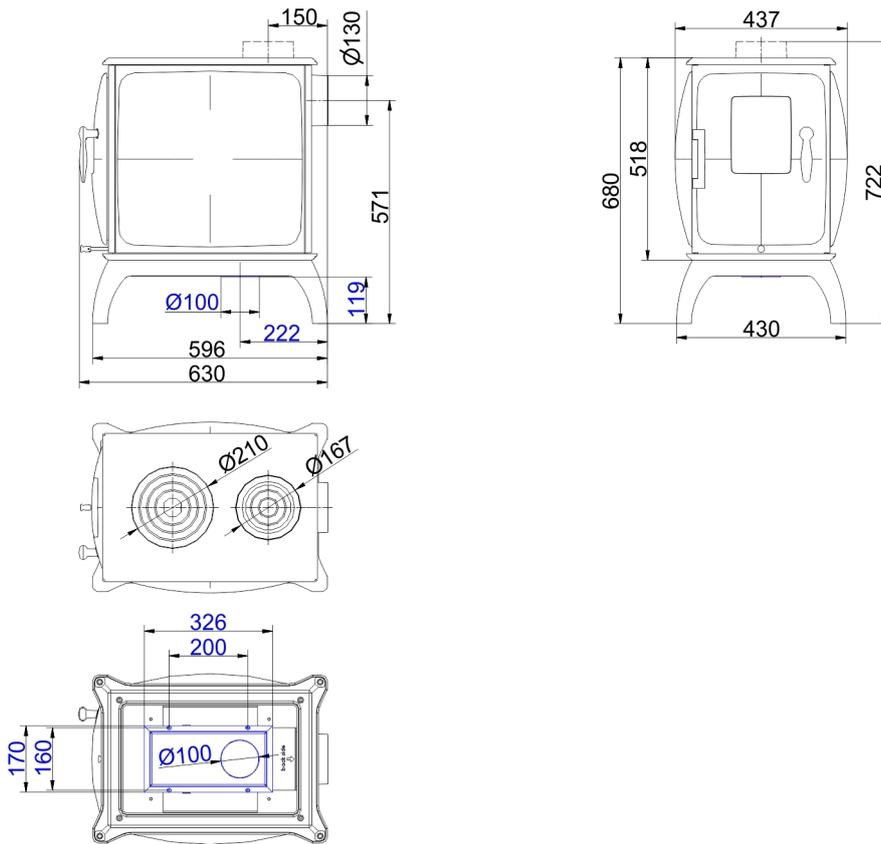
**... mit Anschluss für Verbrennungsluft**
