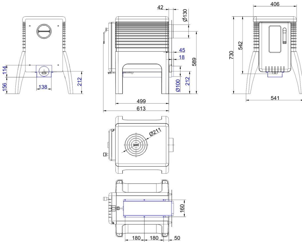
**... mit Anschluss für Verbrennungsluft**
