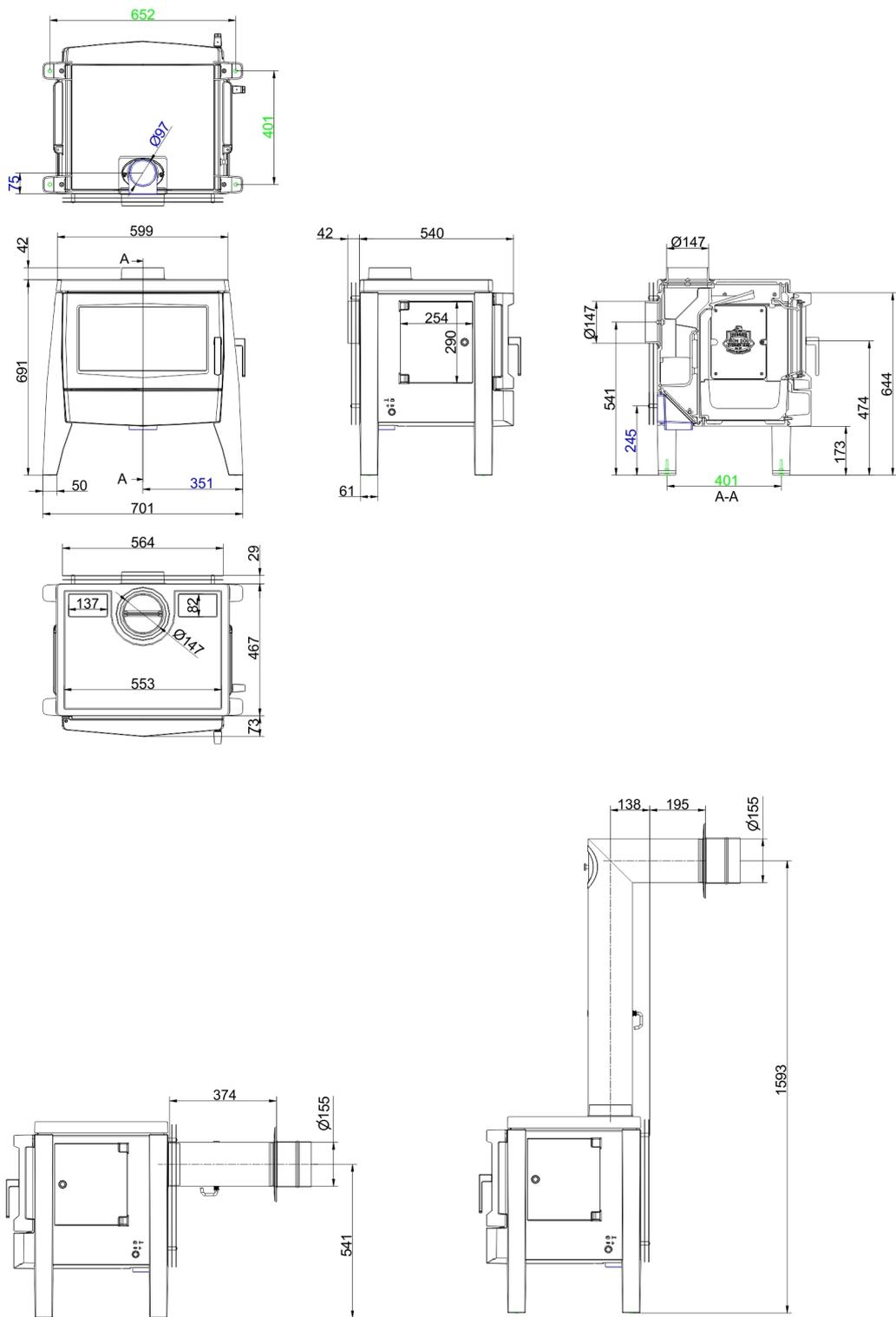
... mit Abgasrohr-Anschlussset horizontal und L
