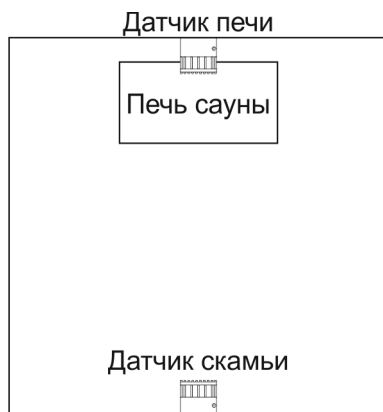
Рисунок 4 : Место установки датчика печи/ датчика скамьи/комбинированного датчика скамьи
