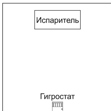
Рисунок 5: Место установки датчика влажности/комбинированного датчика скамьи
